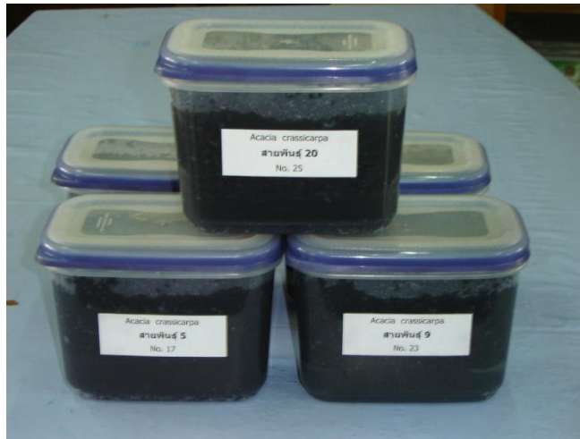
แช่ถ่านในสารละลายอิ่มตัวของโซเดียมคลอไรด์
